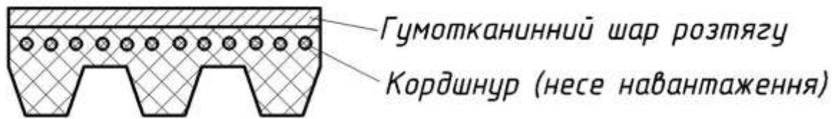
Рисунок 10.7 – Переріз поліклинового пасу
